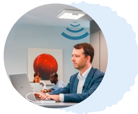
Datenübertragung per infrarotem Licht, von der Zimmerdecke zum Rechner und zurück ©Signify
