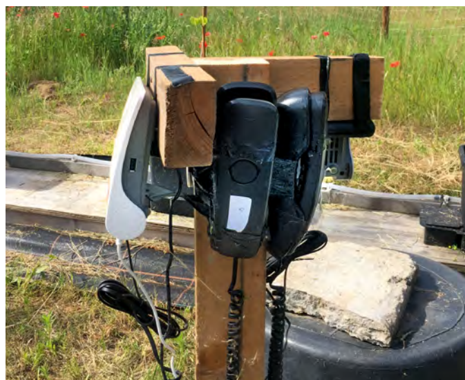
Ein W-LAN Router (unter dem schwarzen Kübel) und mehrere DECT-Telefone rufen das Elektromagnetische Feld im Versuch hervor.
