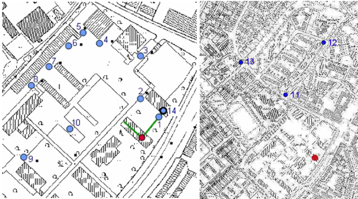
Abb. 4 : Lage der Messpunkte (blau) im Umfeld der TETRA-Sendeanlage (rot) © LVermA NRW/BR K
